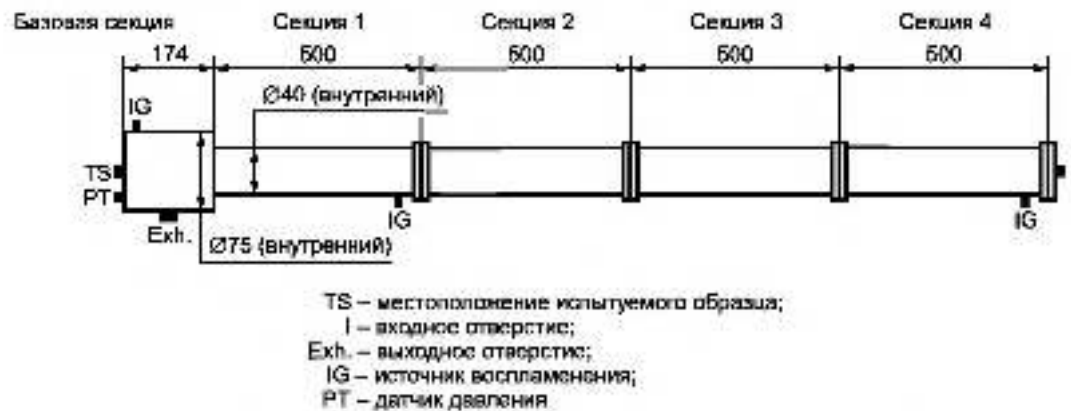
Рисунок 21 — Установка для испытаний дыхательных и дренажных устройств
